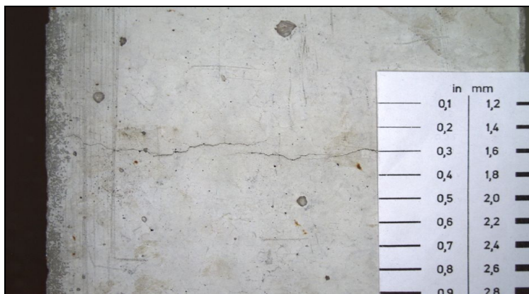
Abb. 1: Manuelle Rissaufnahme mit analoger Risslehre und Fadenzähler (Risslupe)
